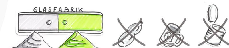
In der Glasfabrik angekommen wird das Altglas fein sauberlich gereinigt und weiter sortiert. Verunreinigungen wie Keramik, Plastik und Metall werden maschinell und händisch entfernt.
